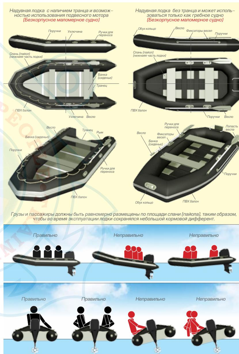
Грузы и пассажиры должны быть равномерно размещены по площади слани (пайола), таким образом, чтобы во время эксплуатации лодки сохранялся небольшой кормовой дифферент.
