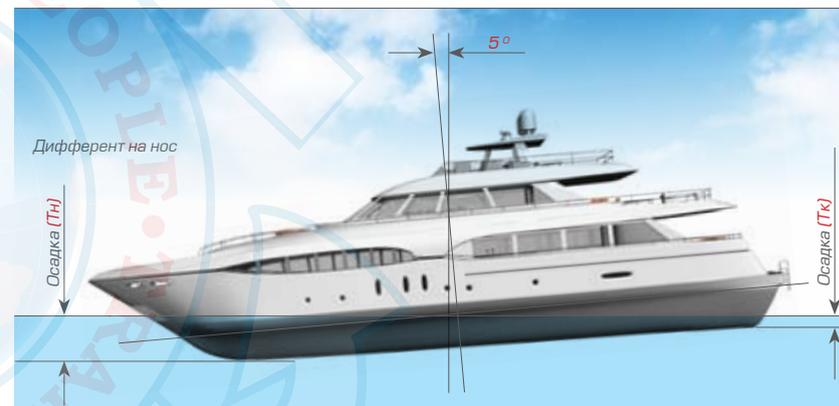
Отношение высоты борта к осадке H/T влияет на остойчивость, непотопляемость и вместимость судна, т.е. определяет запас водоизмещения. С ростом отношения H/T увеличивается парусность судна.
