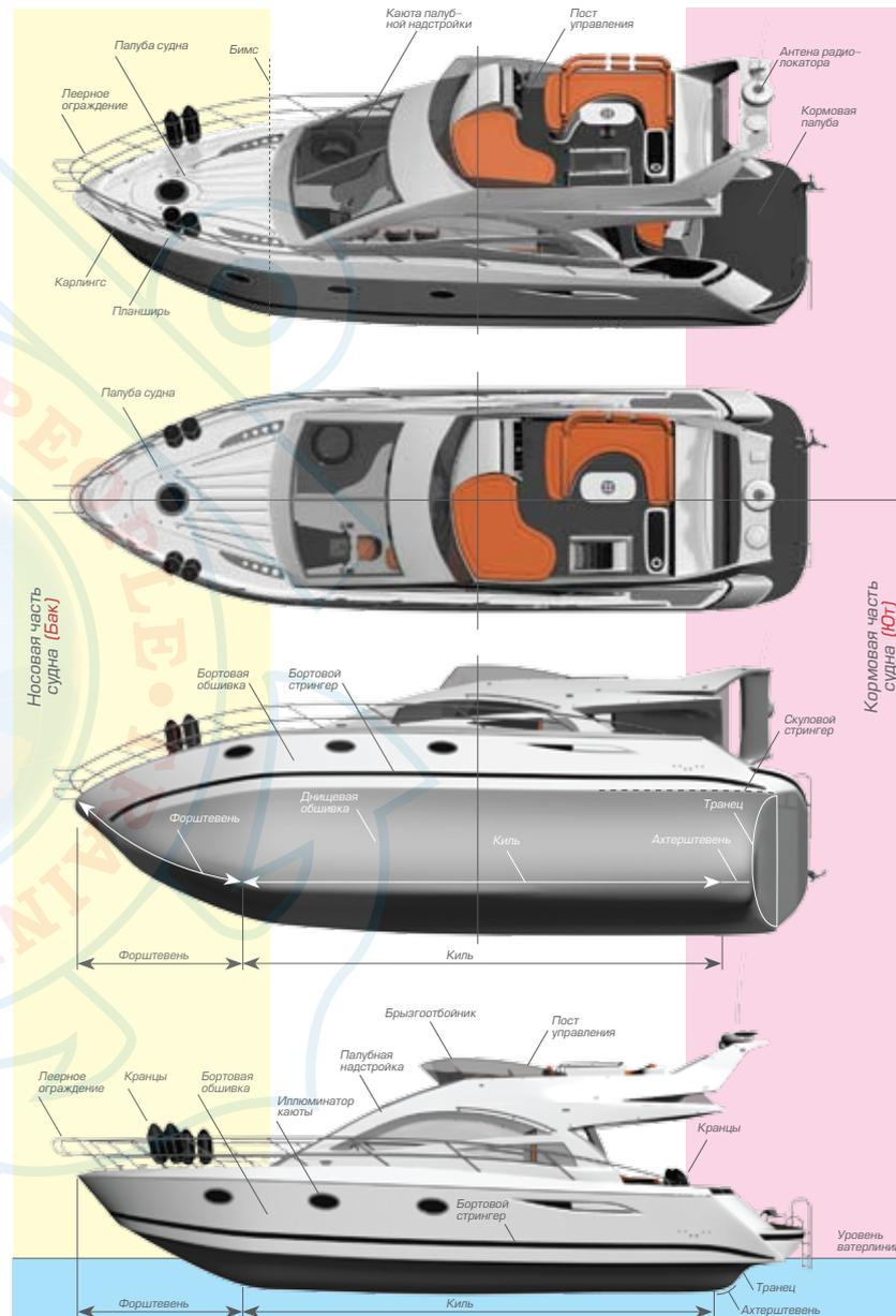
БИМСЫ - поперечные балки подпалубного набора, проходящие от борта до борта. При наличии вырезов в палубе бимсы разрезаются и называются полубимсами. Они одним концом соединяются со шпангоутом, а другим крепятся к массивному комингсу, который окаймляет вырез в палубе, с целью компенсации ослабления палубного перекрытия вырезами.
